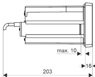
Schalttafel ausbruch:  $282^{+0,5} \times 88^{+0,5}$  [mm]
